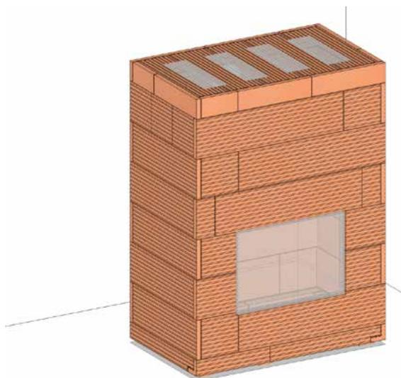
Завершить монтаж внешней оболочки при помощи плит (позиции 17 и 18). Обратите внимание на отверстия для движения воздуха (например, установите вентиляционные решетки заводского изготовления, или выполните отверстия соответствующего сечения в перекрытии по техническим данным производителя каминной топки).
