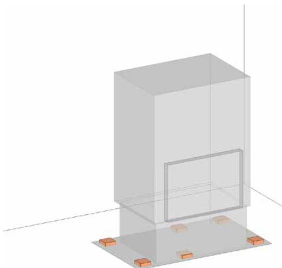
В соответствии с заданными размерами установить в основании элементы позиции 1. В случае попадания элемента позиции 1 на ножку каминной топки, выполнить по месту.
