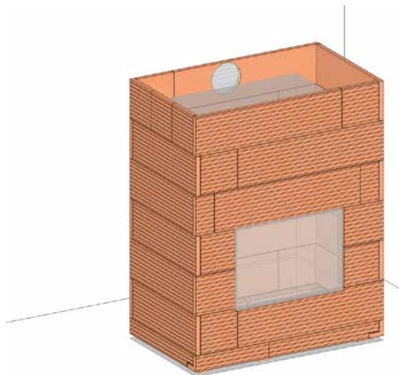
Выложить два ряда из позиций 6 - 8. При необходимости учитывайте отверстие для подключения дымовой трубы.
