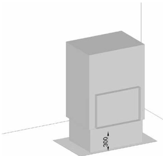
Выставить по уровню каминную топку на предварительно размеченную поверхность и задать высоту до нижней рамки дверцы (рекомендуется – 300 мм или индивидуально). При монтаже учитывайте рекомендации производителя по расстояниям от внешних стенок топки до стен теплоаккумулирующей камеры.
