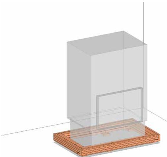
Выполнить два следующих ряда с использованием позиций 4 и 5 с перевязкой на углах относительно позиций 2 и 3, соединив их при помощи смеси НМ.
